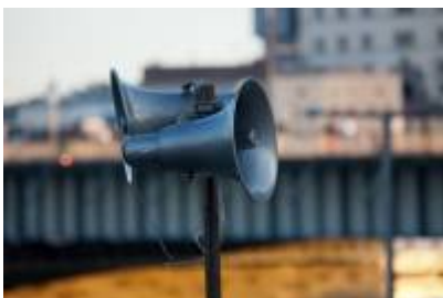
Bild 23: Für die Installation werden Druckkammerlautsprecher verwendet
